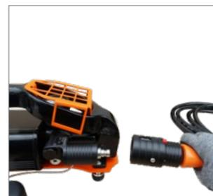
peut être connecté à la pompe manuelle hydraulique PML30 ou à la PML10
